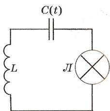
В момент времени, когда напряжение на конденсаторе максимально, его ёмкость скачкообразно уменьшают на долю  $\varepsilon = | \Delta C | / C$ . Через четверть периода  $\pi\sqrt{LC}/2$  ёмкость скачкообразно увеличивают до прежнего значения, ещё через четверть периода ёмкость вновь скачкообразно уменьшают на долю  $\varepsilon$  и так далее. При определённых условиях в схеме могут возбуждаться незатухающие электрические колебания.
