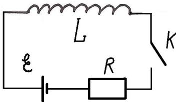
Пусть сначала ключ разомкнут, тока в цепи нет; после его замыкания возникнет ток, который будет проходить через катушку индуктивности, вследствие чего будет возрастать магнитный поток пронизывающий эту катушку, то есть она будет запасать магнитную энергию  $W = LI^2/2$ .
