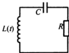
Когда напряжение на конденсаторе равно нулю, ток в индуктивности максимален  $I_{max}$  и мало меняется. Если время  $\tau$  мало по сравнению с  $q = I_{max}\tau$  характерным временем изменения тока, то на конденсатор придёт заряд  $q = I_{max}\tau$ .
