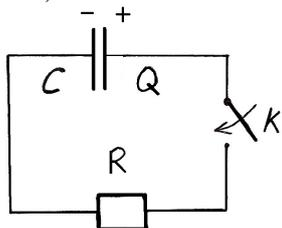
Пусть у нас есть заряженный ( $Q$ ) конденсатор с ёмкостью  $C$ . Если обкладки конденсатора соединить проводом, то по проводу потечёт ток, а конденсатор будет разряжаться. Пусть  $I, Q, \varphi$  — мгновенные значения тока, заряда положительной обкладки и разности потенциалов между обкладками.
