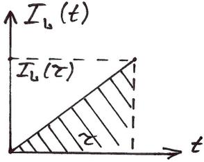
Отсюда следует, что  $I'_L(t) = \frac{\mathcal{E}}{L} = \text{const}$ , пусть ключ  $K$  замкнули на время  $\tau$ , ток сразу через катушку не идёт. Теперь, так как  $I_L = \frac{dq_L}{dt}$ , то  $dq_L = I_L dt$ .
