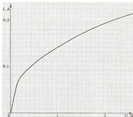
В схему включён нелинейный элемент (лампочка накаливания  $L$ ), вольт-амперная характеристика которой представлена на рисунке.
