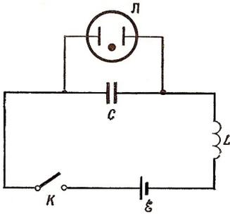
Доказать, что при значениях  $\mathcal{E} = 34$  В,  $U_{заяс} = 64$  В,  $U_{гаиш} = 22$  В при замыкании ключа  $K$  неоновая лампа вспыхнет только один раз.
