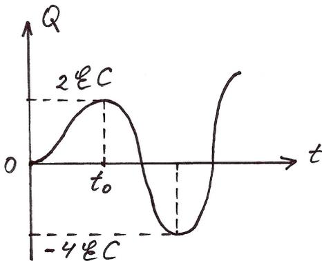
Из  $\dot{Q}(t) = -3\mathcal{E}\sqrt{\frac{C}{L}} \sin \omega t, t \geq t_0$  находим, что
