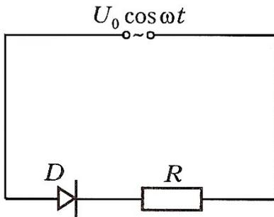
**Решение**  $\mapsto$  Если бы диод обладал одним и тем же сопротивлением  $r$  при протекании тока в цепи в обоих направлениях, то средняя мощность тепловых потерь в ней определялась бы по закону Джоуля-Ленца. С учетом закона Ома, для этого случая имеем:
