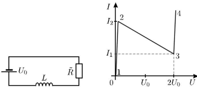
**Решение**  $\mapsto$  После замыкания цепи электронный прибор начнёт работать на участке 1–2 его характеристики. При этом уравнение, описывающее изменение силы тока  $I$  в цепи со временем  $t$ , будет иметь вид:  $L\frac{\Delta I}{\Delta t} = U_0$ ; откуда следует, что  $LI = U_0t$ , то есть сразу после замыкания цепи сила тока в ней будет нарастать прямо пропорционально времени.
