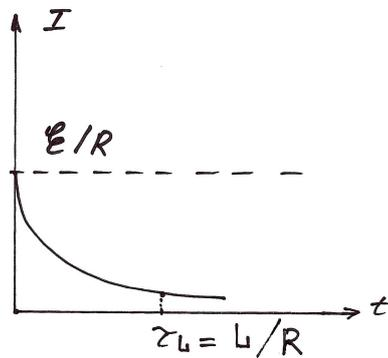
(процессы становления после замыкания ключа  $K_1$  и размыкания  $K_2$ )
