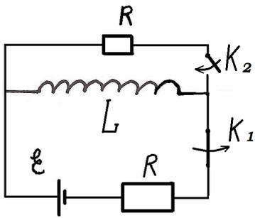
Поставим дополнительную нагрузку параллельно катушке и одновременно откроем  $K_1$  и закроем  $K_2$ . Тогда энергия запасённая в катушке пойдёт выделение тепла в нагрузке.
