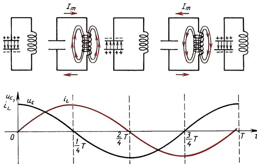
Конденсатор стал бы разряжаться через катушку и т. д. Процесс этот повторялся бы периодически.
