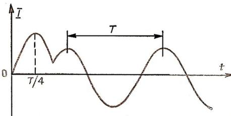
Мы видим, что, когда неоновая лампа гаснет, напряжение на конденсаторе может изменяться от  $34 \text{ В} - 20 \text{ В} = 14 \text{ В}$  до  $34 \text{ В} + 20 \text{ В} = 54 \text{ В}$ , т. е. оно ни разу не достигает значения, при котором лампа может вновь загореться. Вид функций  $U(t)$  и  $I(t)$  показан на рисунках. Объяснить такой вид функции предоставляется читателю.
