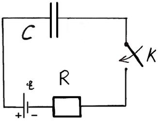
Источник возбуждает ток, заряжающий конденсатор, электрические заряды на обкладках конденсатора препятствуют прохождению тока и уменьшают его. Уравнение  $Q = C\varphi$  остаётся неизменным, остальные два уравнения запишутся как:
