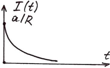
Следовательно, при  $t \rightarrow \infty$  выражение  $a = I(t)R + Q(t)/C$  примет вид  $a = Q/C$ , так как  $\lim_{t \rightarrow \infty} I(t) = 0$ , тогда
