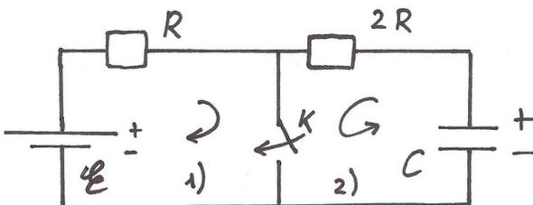
**Решение:** Когда ключ  $K$  замкнут, во втором контуре будут происходить колебания, но в силу того, что ключ замкнули на достаточно малое время, эти колебания можно считать малыми, а следовательно токи во всех контурах приблизительно равны.
