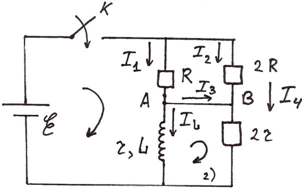
**Решение:** Поскольку  $AB$  обладает нулевым сопротивлением, то  $\varphi_A = \varphi_B$  (точки одинакового потенциала). Запишем правила Кирхгофа для контуров:
