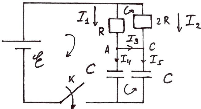
**Решение:** Так как ёмкости конденсаторов одинаковы, то  $Q = C\varphi$  выполняется для обоих конденсаторов в любой момент времени, следовательно,  $I_4 = I_5 = I_C$ .
