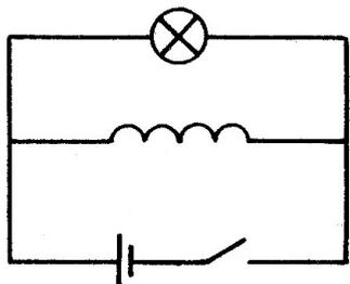
Если электрическую лампу подключить параллельно катушке индуктивности, то при размыкании рубильника лампа ярко вспыхивает, это говорит о том, что магнитное поле также обладает энергией и эта энергия может превращаться в другие виды.
