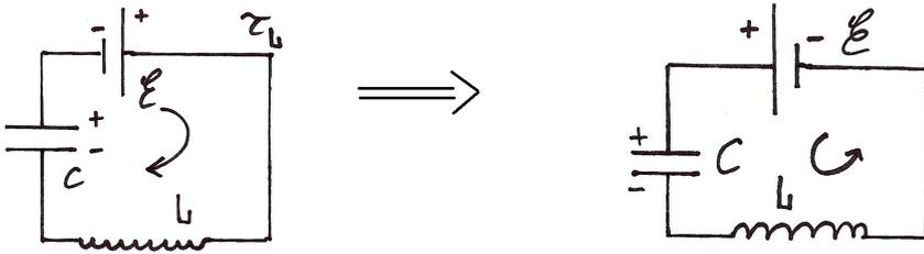
Источник вынимают тогда, когда  $I = 0$ , следовательно,  $A_{\text{внеш}} = \Delta W_{\text{системы}} = Q^2/2C$  (изменение энергии конденсатора).
