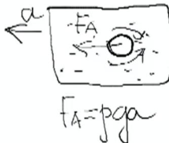
Рис. 1. Жидкость «затекает» под тело при равноускоренном движении
