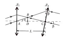
Поскольку из линзы  $\mathcal{I}_2$  пучок выходит параллельно её главной оптической оси, то точка B должна быть фокусом линзы  $\mathcal{I}_2$  и лежать на её главной оптической оси, то есть  $BC = F_2$ .
