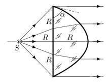
**Решение**  $\mapsto$  Пусть материал линзы имеет показатель преломления n, а скорость света в вакууме равна c. Тогда скорость света, распространяющегося внутри линзы, равна c/n. Так как линза осесимметрична, а фронт прошедшей через неё волны становится плоским, то времена распространения света от источника по путям ABC и ADE (см. рис.) должны быть одинаковыми:  $\frac{R\sqrt{2}}{c} + \frac{R}{c} = \frac{R}{c} + \frac{R}{c/n}$ .
