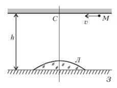
**Решение**  $\mapsto$  Построим изображение мухи в оптической системе линза — зеркало — линза. На рисунке точка  $M_1$  — первое изображение мухи, даваемое линзой после отражения лучей от зеркала. Запишем формулу линзы для первого случая:  $\frac{1}{h} + \frac{1}{a} = \frac{1}{F}$  и для второго:  $-\frac{1}{a} + \frac{1}{b} = \frac{1}{F}$ .
