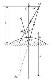
Отсюда находим искомое расстояние:  $b=\frac{Fh}{2h-F}=22c$ м. Из подобия треугольников ОСМ и  $ODM_2$  имеем  $\frac{CM}{DM_2}=\frac{v\triangle t}{u\triangle t}=\frac{h}{b}$ , где u — скорость изображения мухи. Таким образом,  $u=v\frac{b}{h}=0.2c$ м/c.
