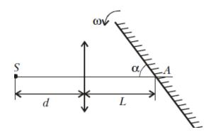
**Решение**  $\mapsto$  Построение изображения источника в данной оптической системе показано на рисунке. Здесь  $S_1$ - изображение источника, даваемое линзой,  $S_2$ - изображение "источника"  $S_1$  в зеркале. Из формулы линзы  $\frac{1}{d} + \frac{1}{f} = \frac{1}{F}$  находим  $f = \frac{Fd}{d-F} = 5F = 100 cm$ .
