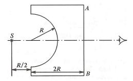
**Решение**  $\mapsto$  Определим положение изображения источника S', даваемое преломляющей поверхностью  $AA_1$ . Виду малости углов имеем  $\alpha/\beta=n$  (см. рисунок). Из теоремы синусов для треугольника OS'D  $(b-2R)/\beta=R/\varphi$ . Аналогично для треугольника OSD  $R/2\alpha=R/\psi$ , откуда  $\psi=2\alpha$  или  $\varphi=\psi-\alpha=3\beta n-\beta$ . Решая второе уравнение относительно b, получаем b=(6n-1)R/(3n-1).
