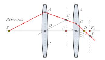
Из точки  $O_2$  строим луч  $O_2E$ , параллельный AB. При пересечении с фокальной плоскостью второй линзы этот луч даст точку E. Согласно второму свойству тонкой линзы луч AB после прохождения через вторую линзу пойдёт по пути CE. Пересечение этой линии с оптической осью второй линзы даст точку D, где сфокусируются все лучи, вышедшие из источника S и прошедшие через обе линзы.
