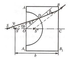
Определим положение изображения источника S'' при преломлении на границе  $BB_1$ . Очевидно, что S''C=b/n. Окончательно, S''C=(6n-1)R/(3n-1)n=15 см.
