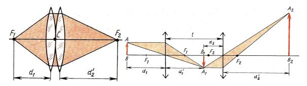
Пусть источник света находится в фокусе первой линзы  $(d_1 = f_1)$ . Пучок света, пройдя первую линзу, далее распространяется параллельно главной оптической оси. Этот пучок, попав на вторую линзу, сходится в её фокусе, то есть  $d_2' = f_2$ . Таким образом, для системы из двух линз получаем  $\frac{1}{d_1} + \frac{1}{d_2'} = \frac{1}{f_{cucm}}$ , или  $\frac{1}{f_1} + \frac{1}{f_2} = \frac{1}{f_{cucm}}$ . Подставляя  $\frac{1}{f} = \Phi$ , получим  $\Phi_1 + \Phi_2 = \Phi$ .
