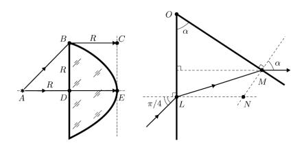
Отсюда получаем, что показатель преломления материала линзы  $n=\sqrt{2}.$
