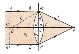
До плоскости BLE все колебания распространяются в однородной среде с одинаковой скоростью, так что на этой плоскости все точки колеблются в одинаковой фазе. Далее волны будут распространяться в среде с другим показателем преломления, следовательно, и с другой скоростью. Однако они должны прийти в фокус F в одинаковой фазе, следовательно, пройти одинаковые оптические пути.
